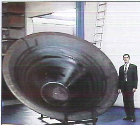
**Genthial**, certifiée ISO 9002 (TÜV), est présente depuis plus de 30 ans dans l'univers du repoussage et du fluotournage sur tous les métaux. Sa capacité dimensionnelle maximale est un diamètre de 4500 mm avec une épaisseur de 20 mm en acier carbone.
